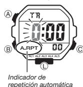
1. En el modo de temporizador, mantenga presionado (A) hasta que el ajuste de las horas del tiempo de inicio de la cuenta regresiva comience a destellar, indicando que está en la pantalla de ajuste.
