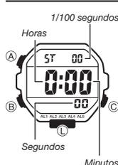
El cronómetro le permite medir el tiempo transcurrido, los tiempos fraccionarios y dos tiempos de llegada.
