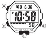
La luz de fondo utiliza un LED (diodo emisor de luz) y un panel de guía de iluminación para iluminar toda la pantalla con el fin de facilitar su lectura en la oscuridad.
