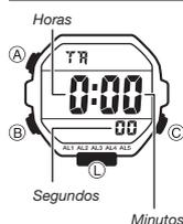
El temporizador de cuenta regresiva puede ajustarse en un rango de un minuto a 24 horas. Suena una alarma cuando la cuenta regresiva llegue a cero.
