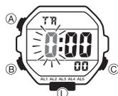
1. En el modo de temporizador, mantenga presionado (A) hasta que el ajuste de las horas del tiempo de inicio de la cuenta regresiva comience a destellar, indicando que está en la pantalla de ajuste.
